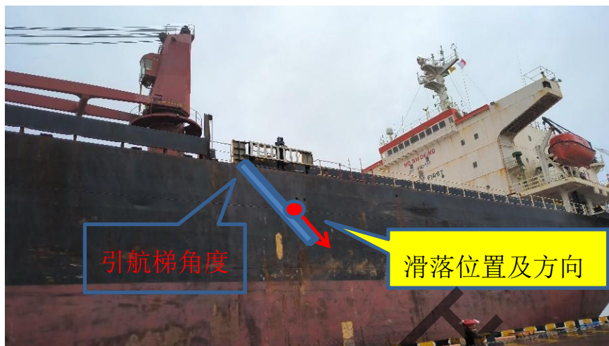
图 8：引航梯角度和人员滑落位置示意图
