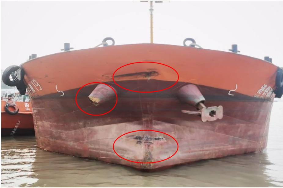
图 29：“港供油 19”轮损坏情况
