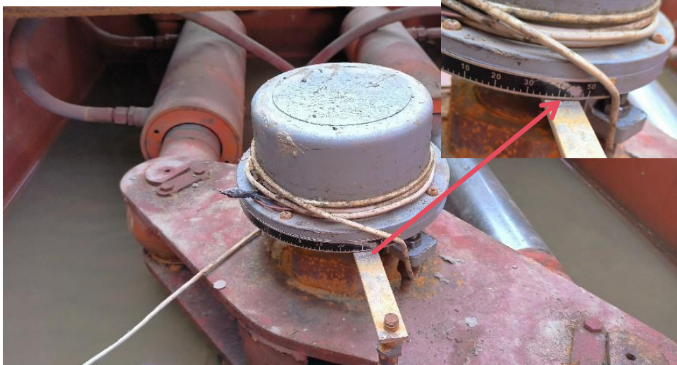
图 6：“浙桐乡槽 00878”轮舵机转向装置及舵角状态
