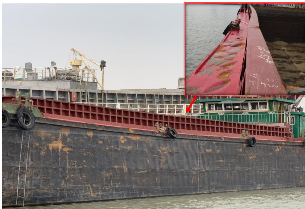
图 9：“皖江泰 XX” 轮船中左舷损坏照片。
