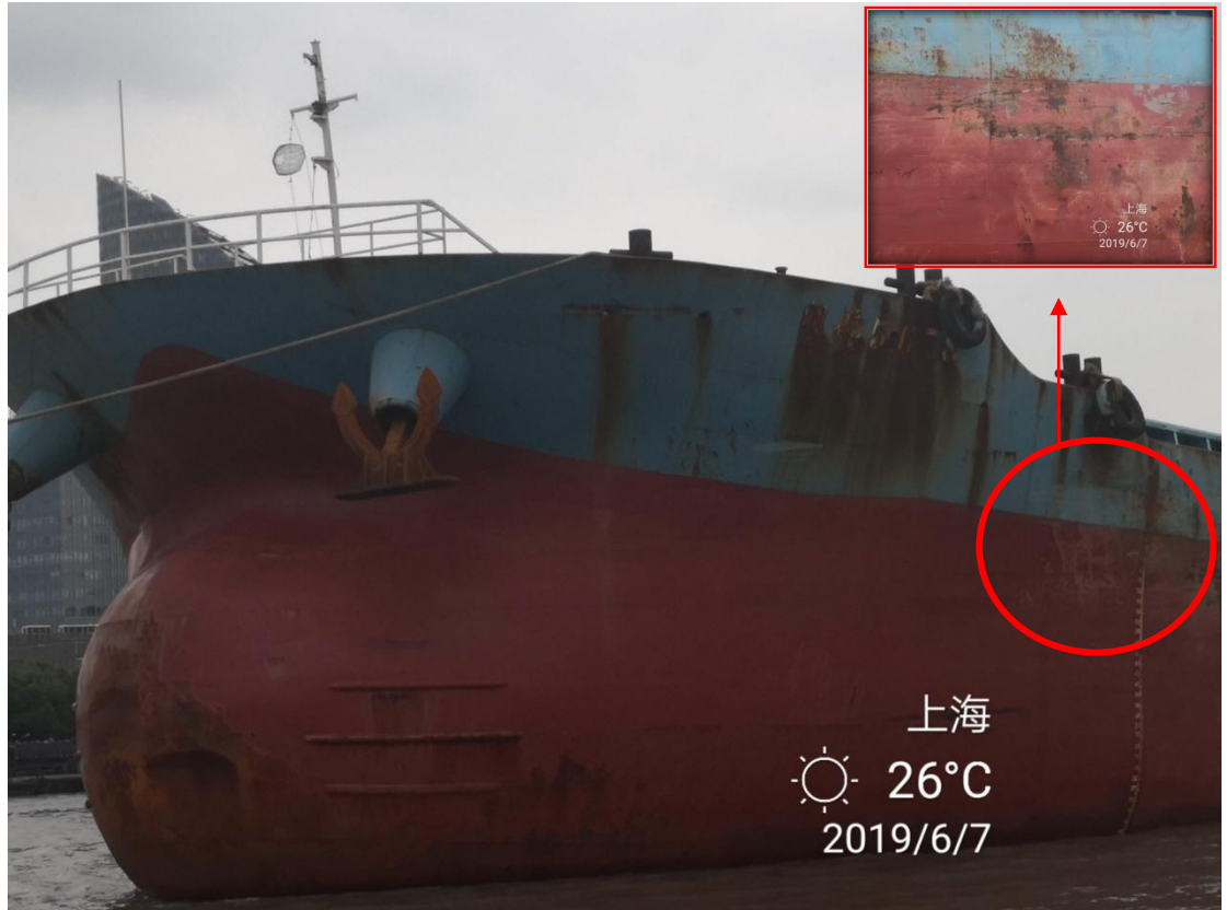
图6：“润航XX”轮左舷损坏情况照片。
