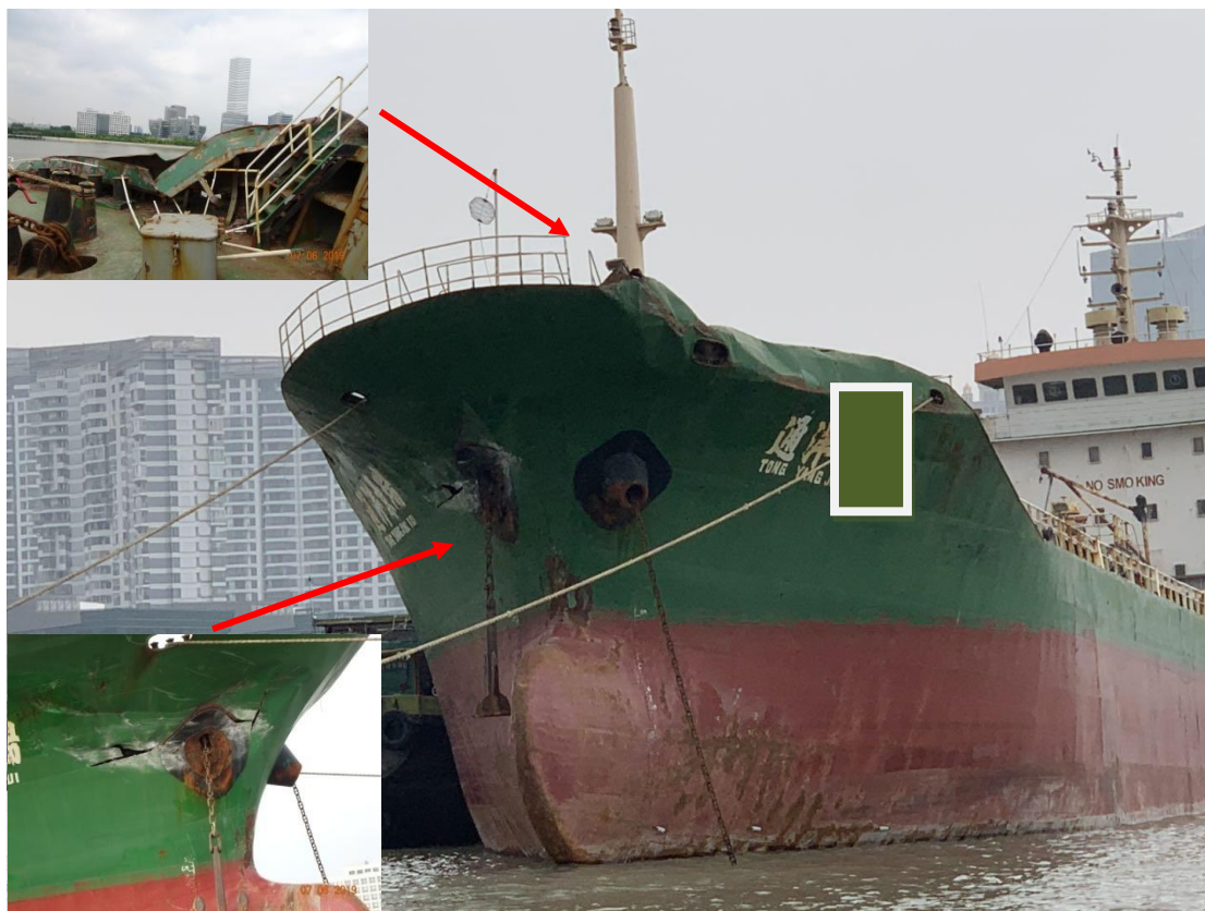
图 8: “通洋 XX” 轮船艏损坏照片
