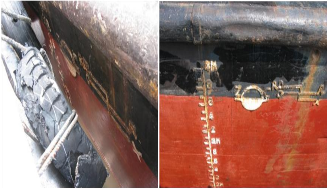
图 4：“兴航海 68”轮左右舷干舷高度
