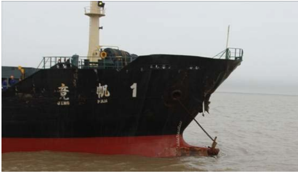
图 5：竞帆 1 轮船艏破损照片
