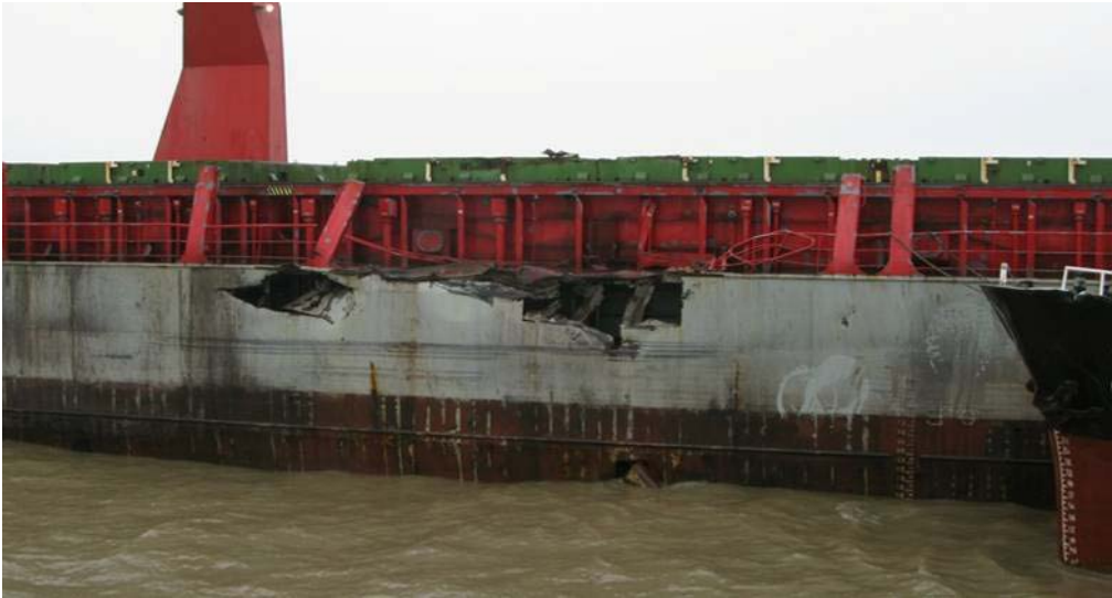
图 3：MAXIMA 轮左舷破口露出水面部分
