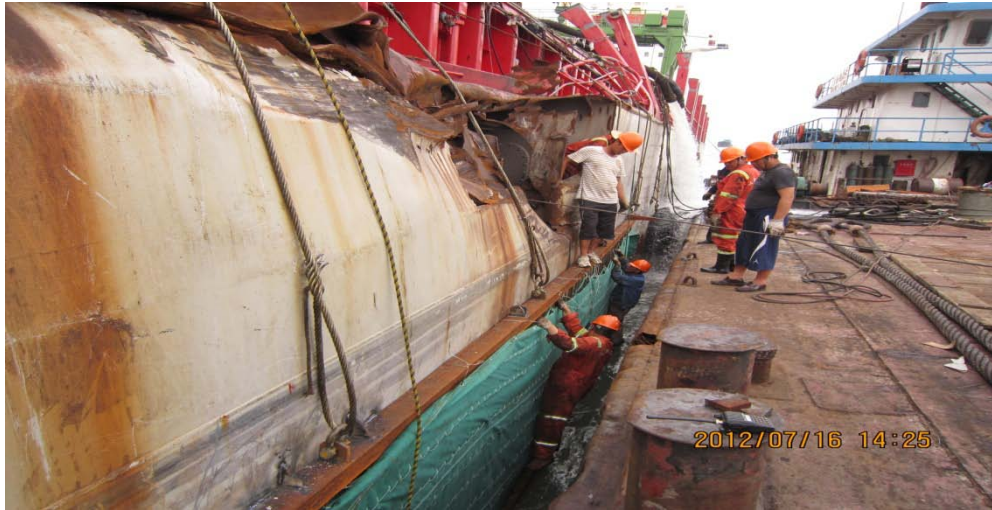
图 4：“MAXIMA”轮左舷水下破口封堵
