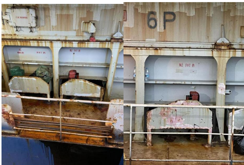
图 3、图 4 NO.2（左）燃油舱的空气管
